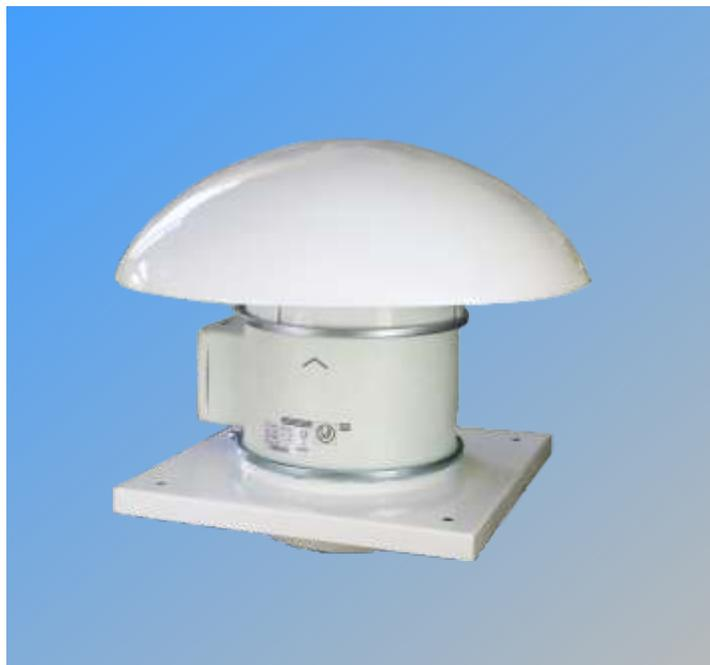
La gama de extractores de tejado helicocentrífugos de cuatro modelos 500, 800, 1300 y 2000, ofrece las características de eficiencia de los modelos TD, pero dentro de su estructura incluye una base tipo marco para su fácil instalación así como un domo que impide el paso de agua y objetos al interior, ambos fabricados en aluminio con acabado tipo poliéster termoendurecible color beige.
