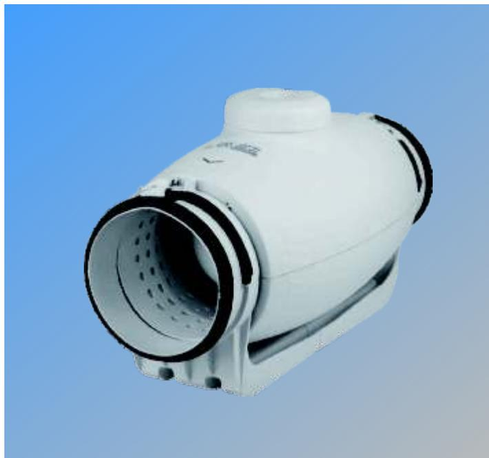
Ventiladores helicocentrífugos de bajo perfil, extremadamente silenciosos, fabricados en material plástico, con recubrimiento interno que direcciona las ondas sonoras y aislamiento fonoabsorbente, juntas de goma en impulsión y descarga para absorber las vibraciones, cuerpo motor desmontable sin necesidad de tocar los conductos.
